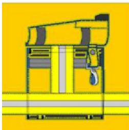
Figura 03 - Desenho esquemático de bolsos, punho com dedal na manga (manguito) e zíper de abertura do casaco de aproximação:
